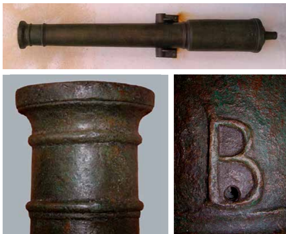
Fig. 6 Smeriglio petriere ad avancarica prodotto molto probabilmente da Battista Morello.
